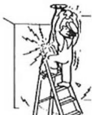
Escadas de alumínio conduzem corrente elétrica, não utilize esta escada próximo a rede elétrica e/ou a fios desencapados.
